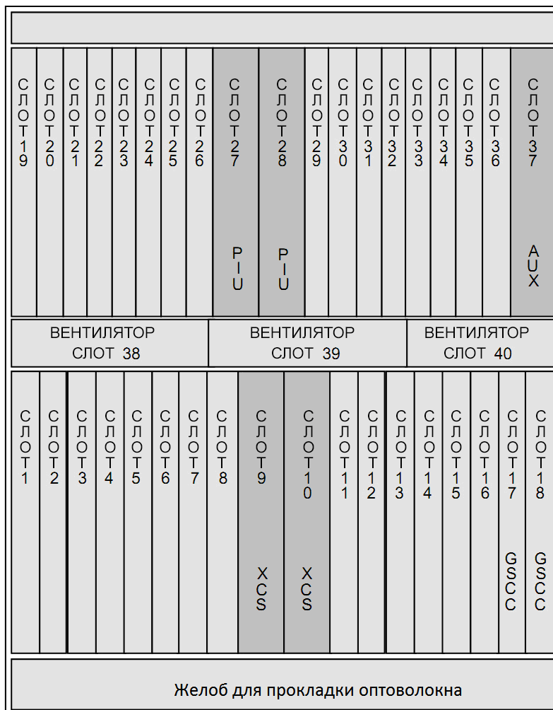
Рис. 2-2 Компоновка слотов в подстативе OptiX OSN 3500
