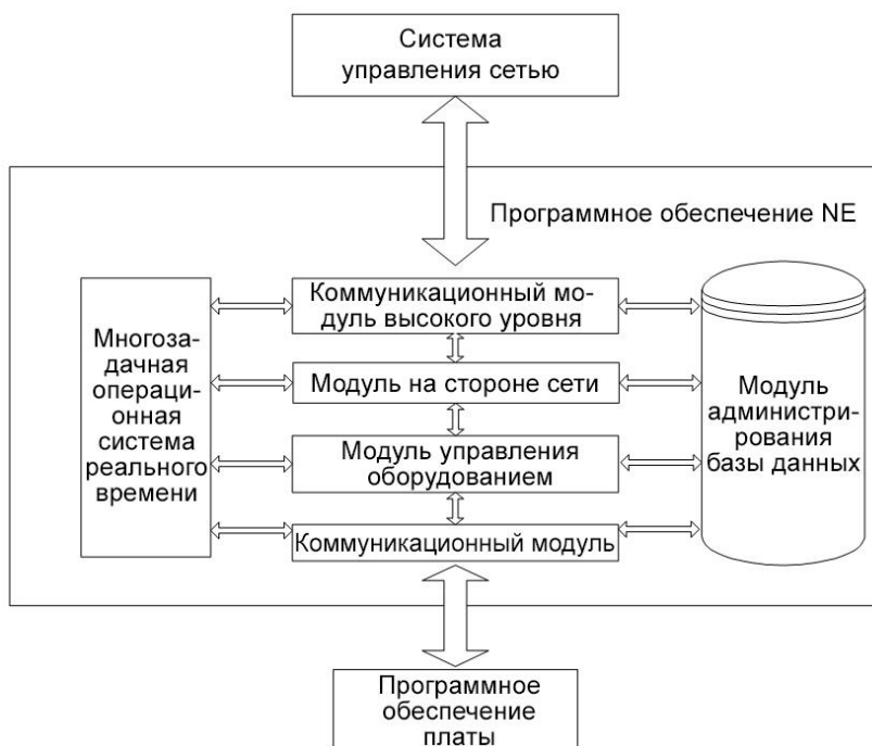
Рис. 2-4 Архитектура программного обеспечения
