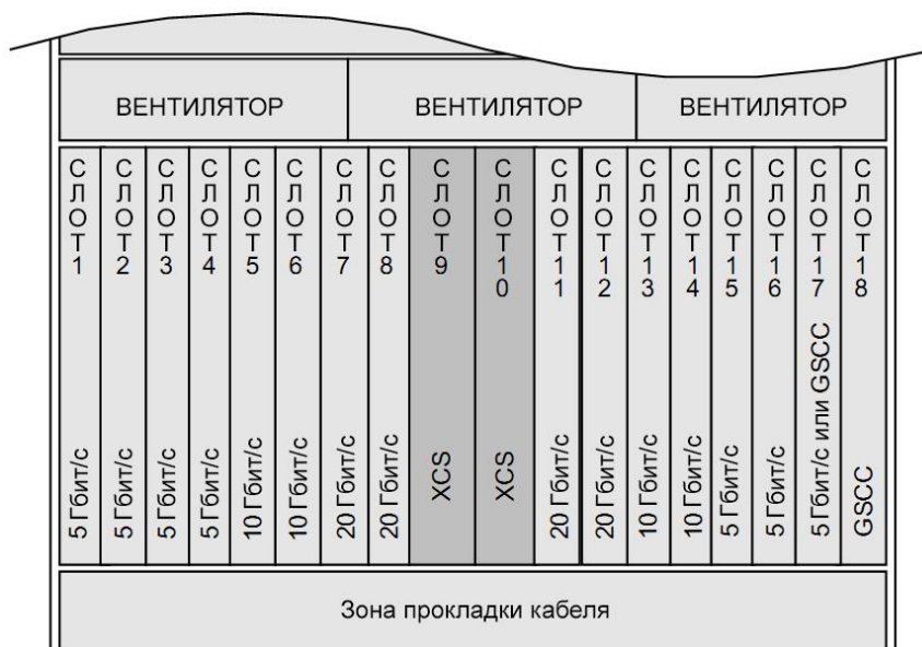
Рис. 4-1 Пропускная способность доступа слотов оборудования OptiX OSN 3500
