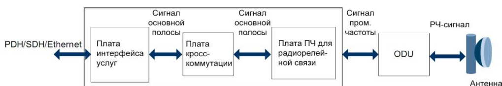
Рис. 4-3 Обработка потока сигналов
